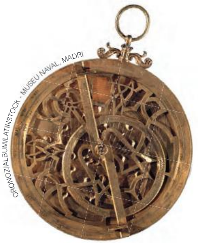
Astrolábio espanhol (século XVI). Museu Naval, Madri, Espanha. O astrolábio era um antigo instrumento, de origem árabe, utilizado para medir a altura dos astros em relação à linha do horizonte, o que permitia determinar a latitude e a longitude do ponto de observação.
